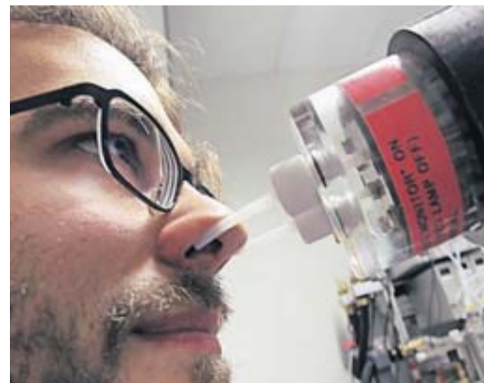
Das Olfaktometer gibt der Testperson einen Geruch vor – gleichzeitig messen die Forscher, wie das Gehirn reagiert. Fotos: Sergej Lepke
