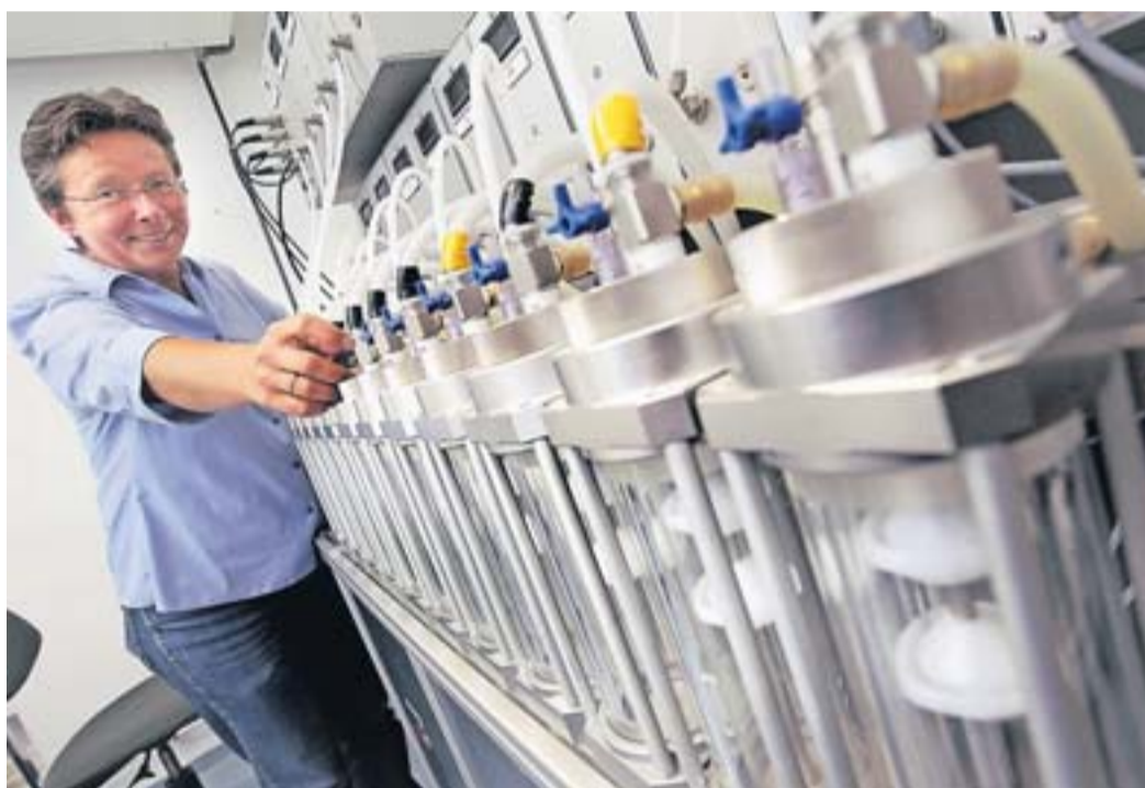
Bettina Pause stellt die Duftkammern des Olfaktometers ein, aus dem Gerüche zur Testperson geleitet werden.
