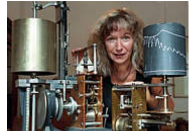
Leipziger Professorin am Kymographen: Fast 100 Jahre altes Gerät zur Puls- und Atemmessung
